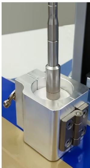
Klammer zur Stabilisierung der Probe
